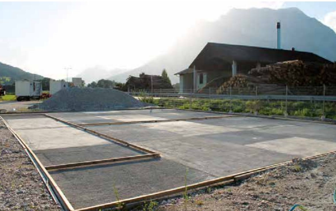
Abb. 5: In einer Kooperation zwischen Smart Minerals GmbH und H. Junger Bauges.m.b.H. hergestellte Versuchsfläche zur Analyse eines möglichen Verstärkungssystems für Brückentragwerke
