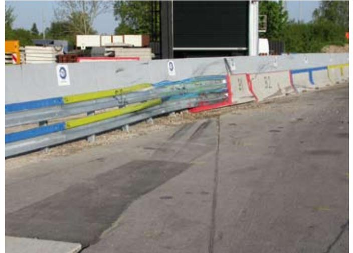
Bild 2a + 2b: Der Übergang zwischen Fertigteil-Leitwand und EDSP-Stahlleitschiene widersteht einem Autobus-Anprall.
