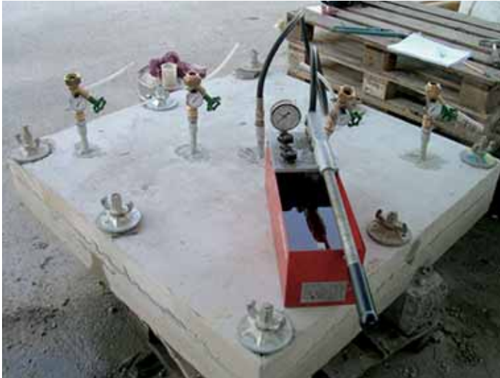
Abb. 2: Versuchsplatten in Sandwichbauweise – Laborversuch
