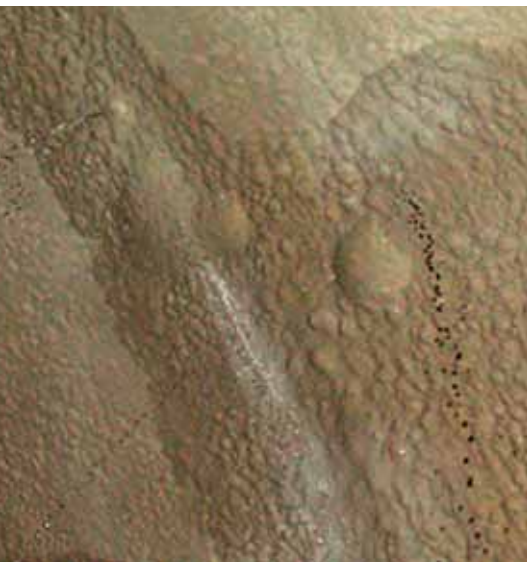
Abb. 4: Blasenbildung bei 10 bar Wasserdruckbelastung – Praxisversuch
