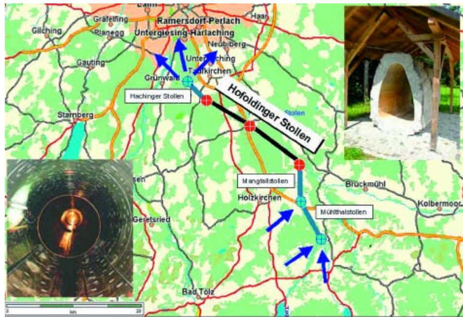
Abb. 1: Lageplan mit Trassenführung mit alter (rechts oben) und neuer Leitung (links unten) Fotos & Grafiken: © Markus Astner
