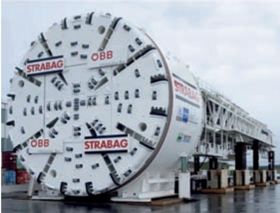
Bild 3: Ansicht Bohrkopf im Herstellerwerk Foto: © Strabag AG
