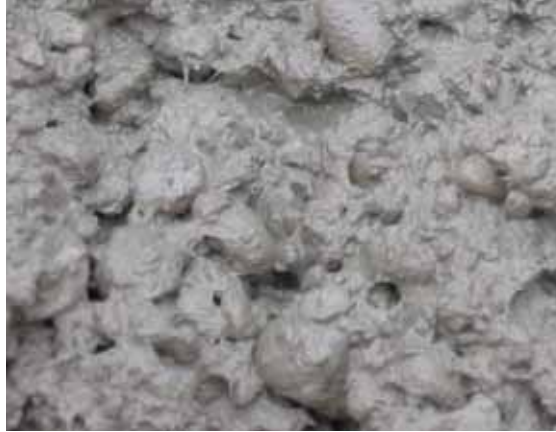
Abb. 9: Frischbeton mit PP-Fasern (2 kg/m³)
