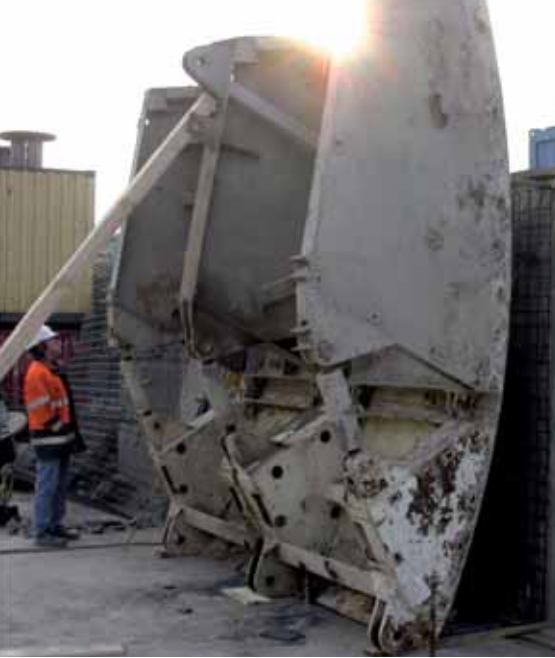
Abb. 11: Schalung bewehrter Probekörper
