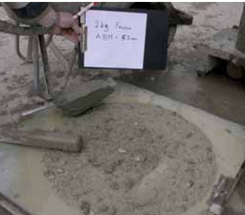
Abb. 5: Entmischung bei Konsistenzprüfung
