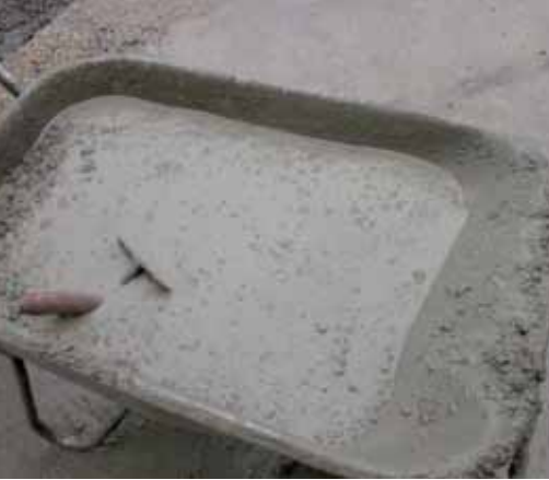
Abb. 4: Wasserabsonderung vor FB-Prüfungen
