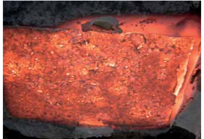
Abb. 9: Versuchskörperunterseite unmittelbar nach dem Abheben vom Brandraum
