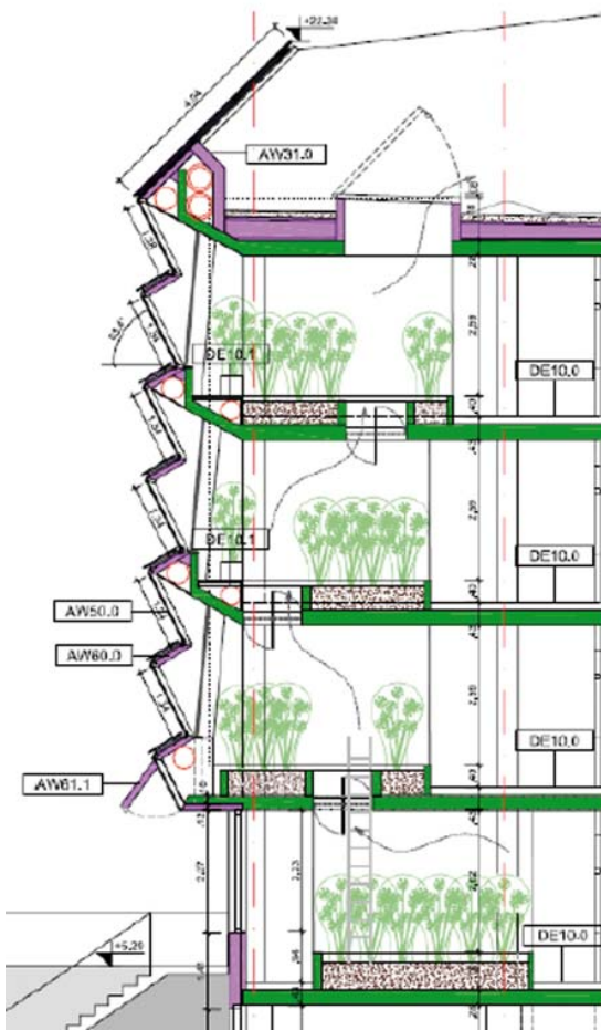
Abbildung 2: ENERGYbase, Ansicht der Pflanzenpuffer
