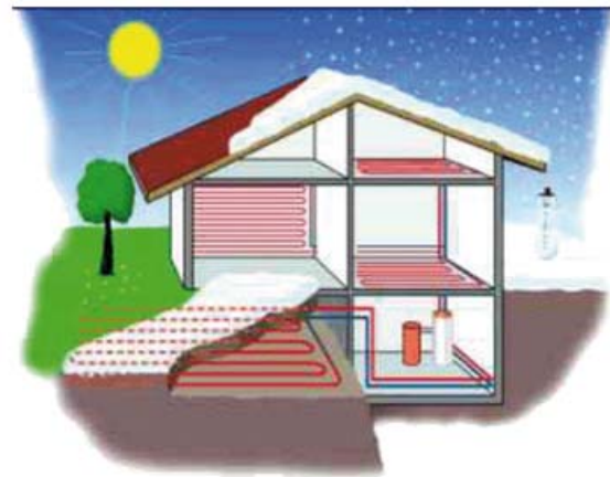
Abb. 2: Flächig verlegte Erdregister
