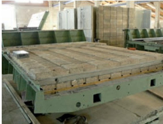
Abb. 1: Bereits bei der Produktion werden die Holzbetonabsorber „Faseton“ mit der Lärmschutzwand verbunden. Alle Fotos: © MABA FTI
