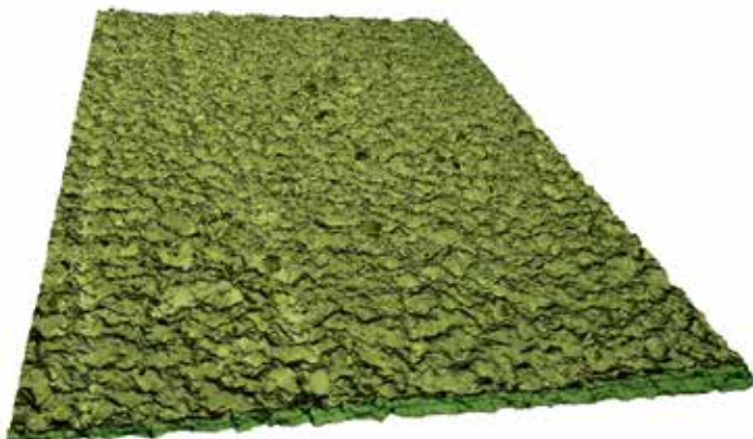
Abbildung 1: Dreidimensionales Oberflächenmodell einer hochdruckwassergestrahlten Fläche sowie zugehöriges Oberflächenprofil (Quelle: VÖZfi)
