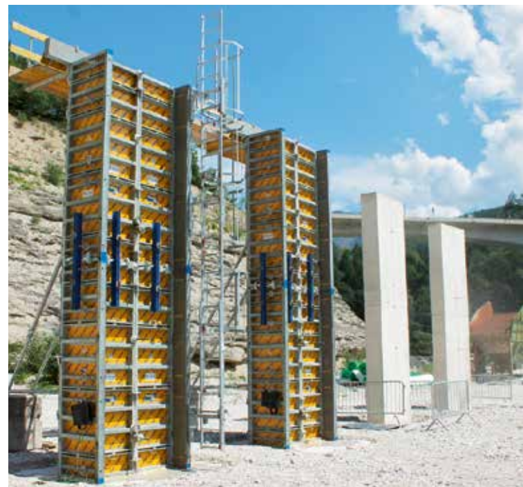
Abbildung 2: Feldversuche mit Versuchswänden aus selbstverdichtendem Beton
