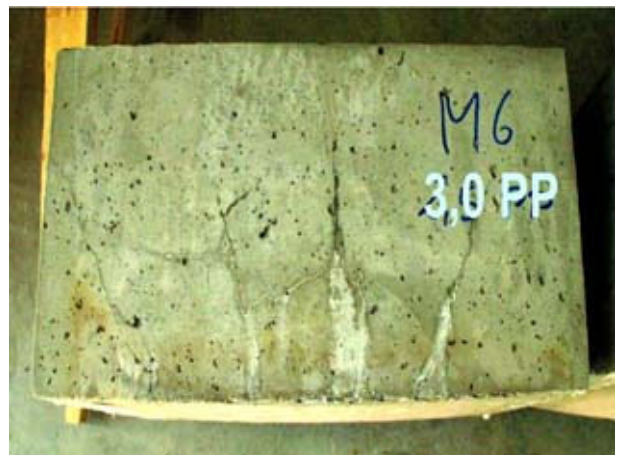
Abbildung 1-13: Stirnflache von M6 nach dem Brandversuch
