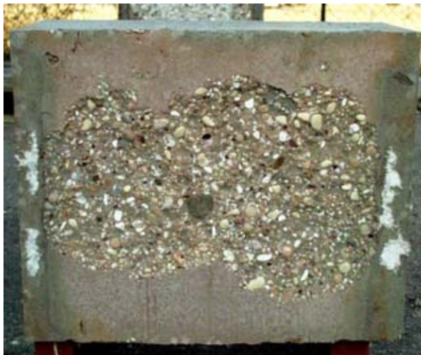
Abbildung 1-8: Oberfläche von M4 (ohne PP-Fasern) nach dem Brandversuch
