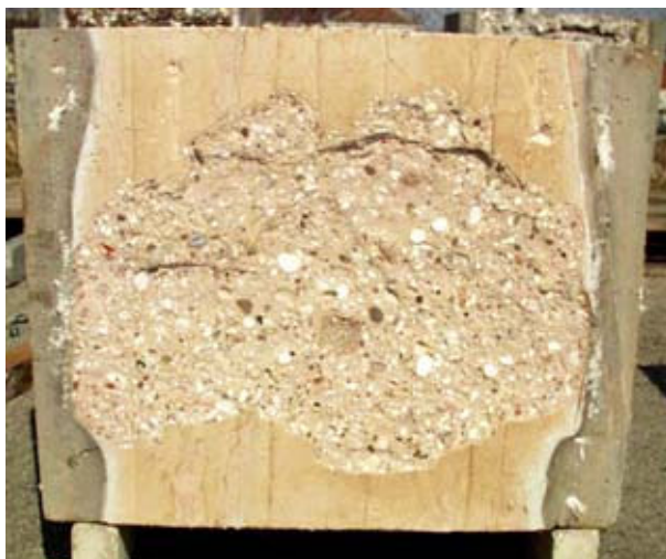
Abbildung 1-4: Oberfläche von M2 (1,5 kg/m 3 ) nach dem Brandversuch
