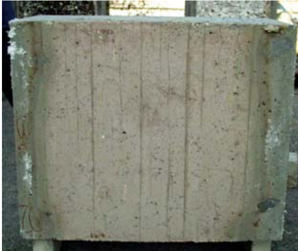
Abbildung 1-10: Oberflache von M5 (1,5 kg/m 3 ) nach dem Brandversuch
