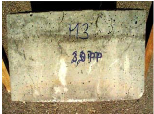
Abbildung 1-7: Stirnfläche von M3 nach dem Brandversuch
