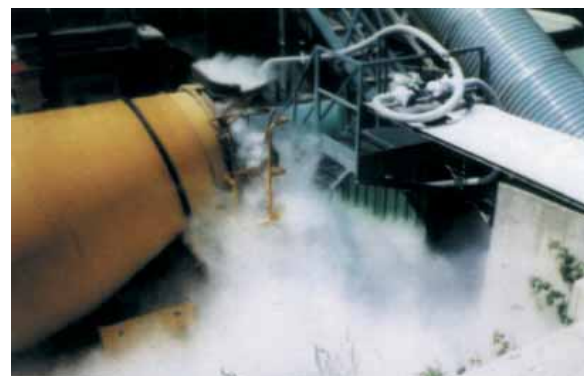
Bild 5: Einblasen des Stickstoffes in die Mischertrommel
