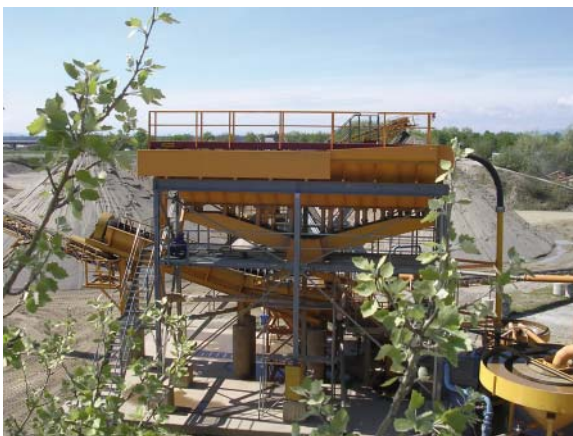
Abbildung 4: Mikroprozessorgesteuerter Sandklassierer für die gleichzeitige Produktion von bis zu zwei unterschiedlichen Kornzusammensetzungen
