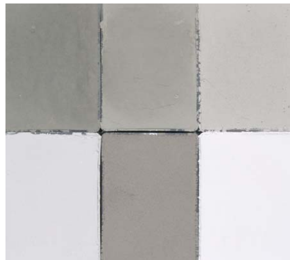
Abbildung 1: Von links oben nach rechts unten: CEM I C 3 A-frei, CEM I, CEM III/B (68 % Hüttensand), Hüttensand gemahlen, Flugasche ungemahlen, Kalkstein gemahlen
