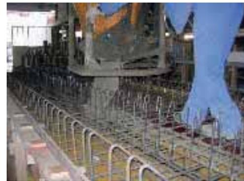
Vorbereitung der Fertigteile zur Ergänzung des Tragwerkes mit Leichtbeton-Ortbeton
