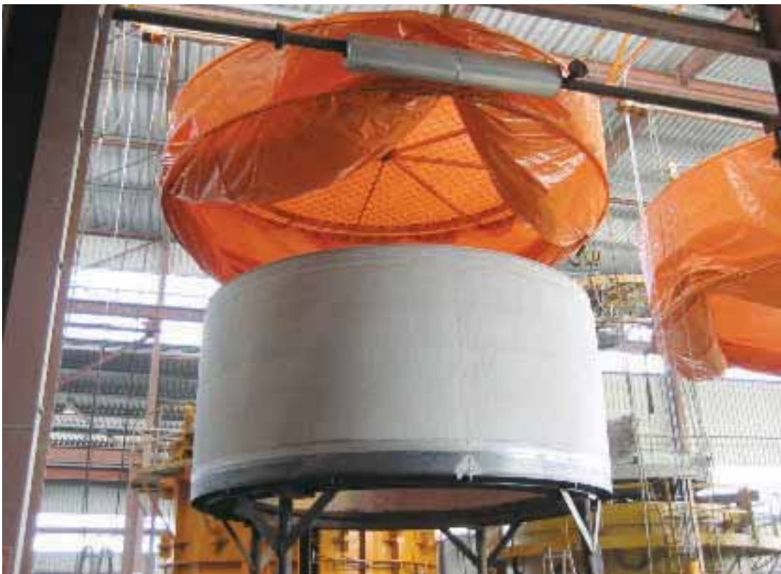
Bild 3: Vortriebsrohr DN 3400 (Wanddicke 50 cm) aus Hochleistungsbeton C 60/75
