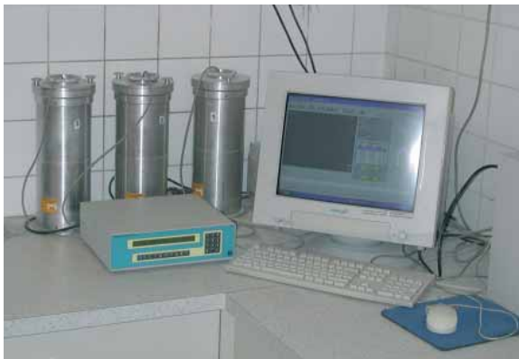
Abbildung 1: Dewar-Gefäße zur Ermittlung der Hydratationswärme gemäß ÖNORM EN 196-9 [3]
