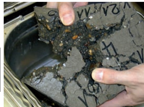
Abb. 2: Beton mS45 nach 56 Frost-Tau-Wechseln Foto: © VDZ, Düsseldorf
