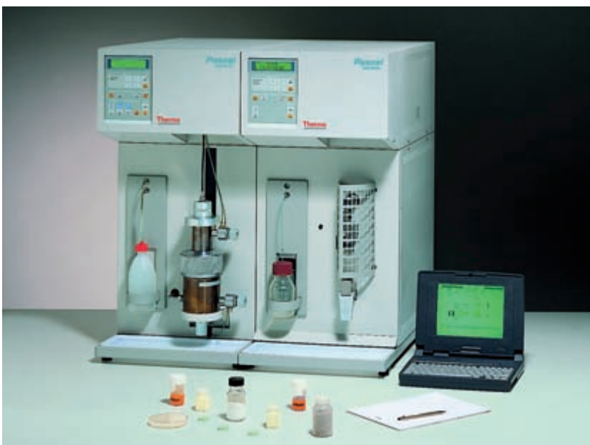
Bild 1: PASCAL Porosimeter, durch das vertikale Befüllen (rechte Seite) bei gleichzeitigem druckkontrollierten Entgasen oberhalb des Wasserdampfsättigungsdrucks sind Porosimetriemessungen an vorgefeuchteten Materialien möglich.
