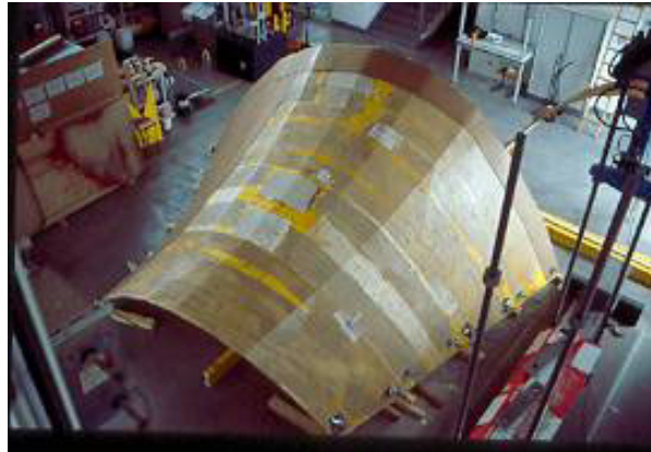
Bild 2 Schalungssystem-Prinzipaufbau mit vorbereiteter Oberfläche
