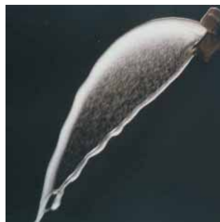
Bild 2: Binäreis = „flüssiges Eis“
