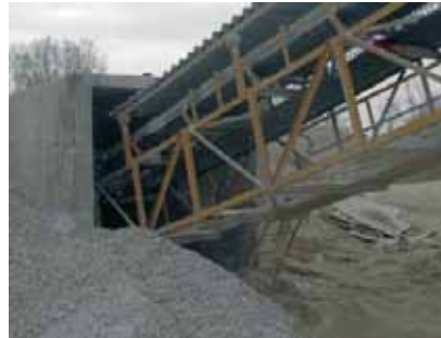
Abb. 5: Kombination Besprühen der Deponie mit gleichzeitigem Unterflurabzug
