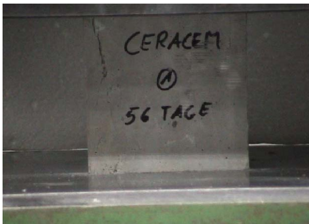
Druckprüfung eines Probewürfels ohne Fasern nach 56 Tagen
