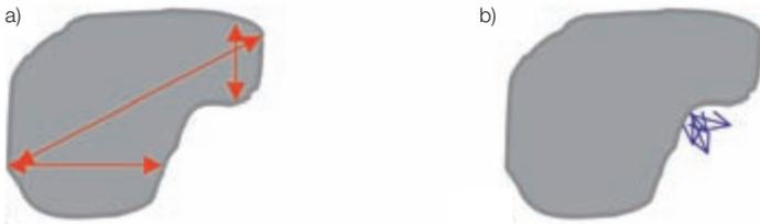
Abb. 9: Messung eines unregelmäßigen Kornes; Erfassungen von verschiedenen Teilrundungen abhängig von der Lage des Kornes zum Laserstrahl (a.) und Streueffekte (b.)
