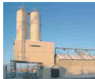
Bild 10: Horizontale und vertikale Bauweise in isolierter Ausführung
