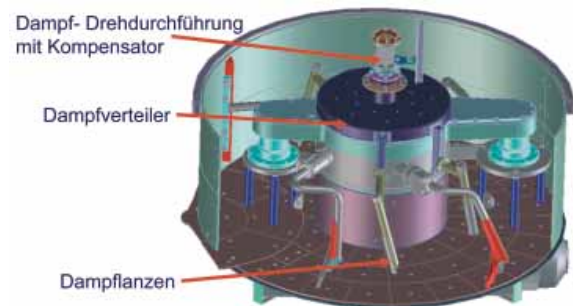
Bild 12: Dampfinjektion für Ringtellermischer (Niederdrucksystem)
