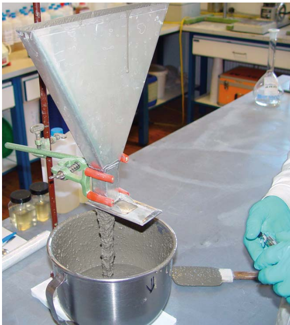
Bild 4.2: Laborversuchsanordnung für Feinbetonversuch – Fließzeit
