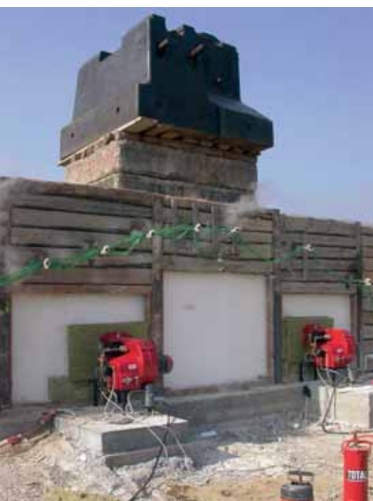
Bild 5: Brandversuch, Kalotte mit 60 Tonnen Auflast in Kalottenmitte
