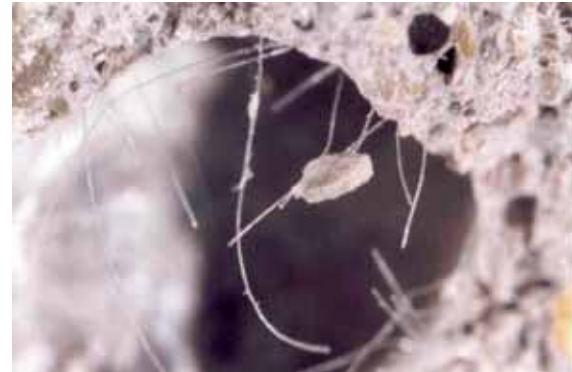
Bild 1: Beton MV 2,0 mit 2,0 kg/m 3 PP-Fasern nach 20° C Lagerung alle Fotos und Grafiken: VÖZFI
