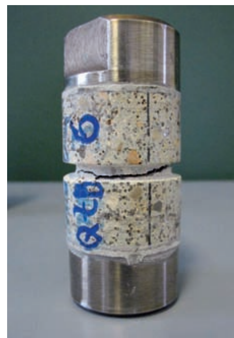
Abb. 4: Gekerbter Probekörper nach dem Versuch
