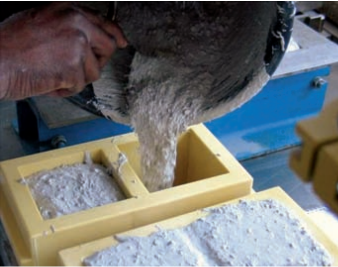
Abb. 2: Frischer, ultrahochfester Faserbeton wird in Probewürfelformen eingebracht. Alle Fotos und Diagramme: © DI Joachim Juhart
