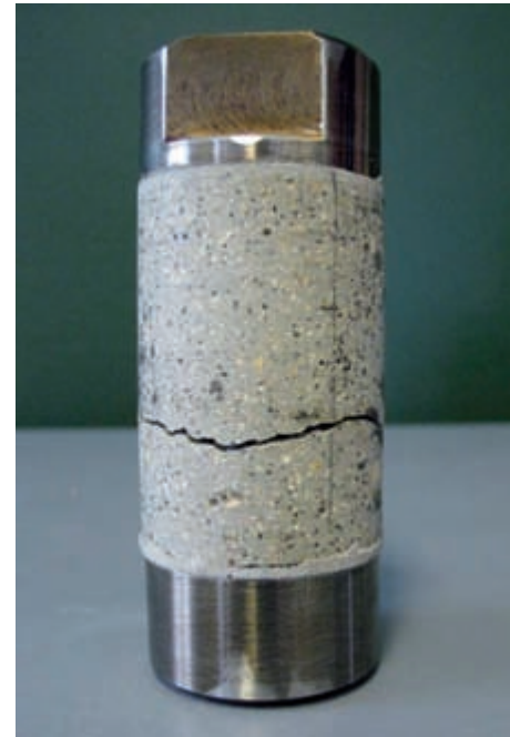
Abb. 3: Ungekerbter Probekörper nach dem Versuch
