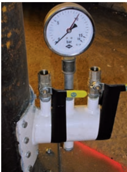
Vorrichtung zur Messung des Schalungsdrucks
