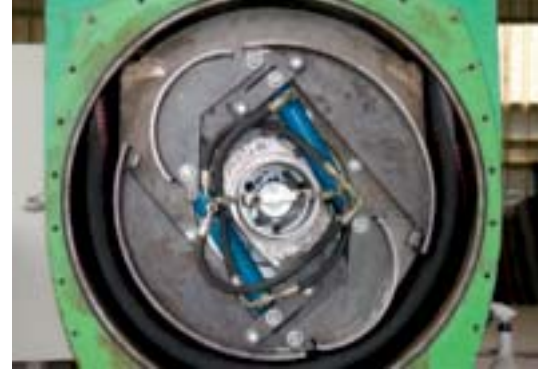
Bild 3: Geöffnete Schlauchquetschpumpe mit einfahrbaren Polschuhen
