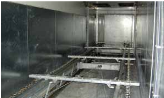
Eislager für 40 Tonnen Brucheis
