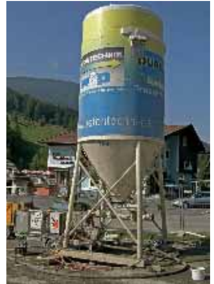
Silo für Trockenbeton mit Misch- und Fördereinrichtung
