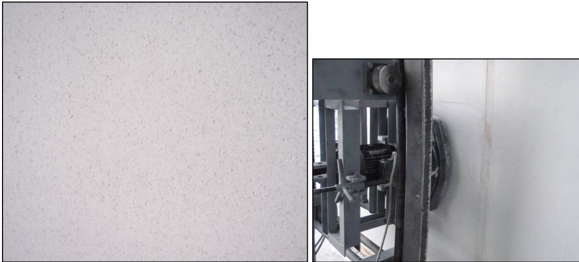
Abbildung 4: Detailaufnahme Oberfläche geschliffener weißer Spritzmörtel; Schleifkopf
