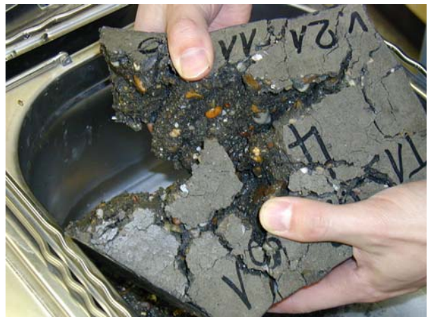
Bild: Silikatstaubhaltiger Probekörper mit (w/z)_{eq} = 0,35 nach 28 Frost-Tau-Wechseln
