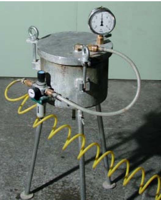
Bild 10: Gerät zur Durchführung von Druckpressversuchen Fotos: © VÖZFI
