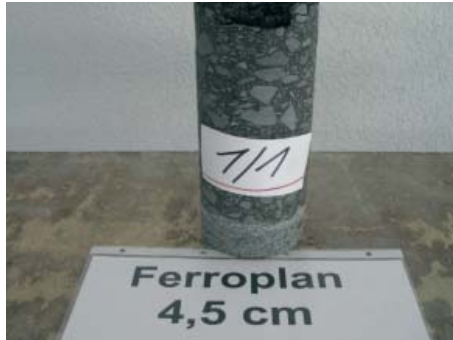
Bild 9: Bohrkern aus Versuchsfeld „Ferroplan“, FP ZW Wetzlar
