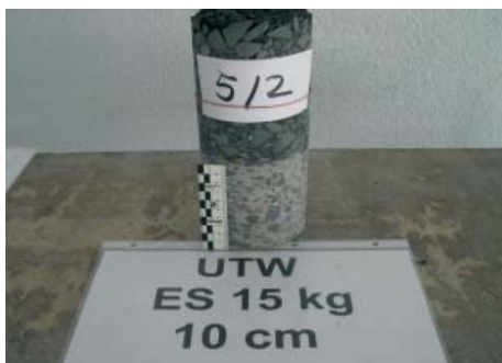
Bild 13: Bohrkern aus UTW-Versuchsfeld, FP ZW Wetzlar
